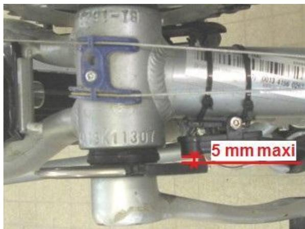
Certains capteurs possèdent un autocollant double face qui vous permet de le fixer provisoirement en attendant sa fixation définitive à l'aide des colliers nylon fournis.
